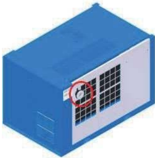
Рис. 32: Патрубок для подачи сжатого воздуха
