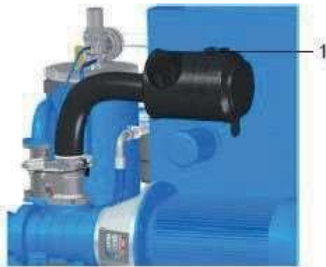
Рис. 41: Расположение воздушного фильтра
