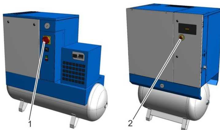
Рис. 1: Расположение предохранительных устройств
