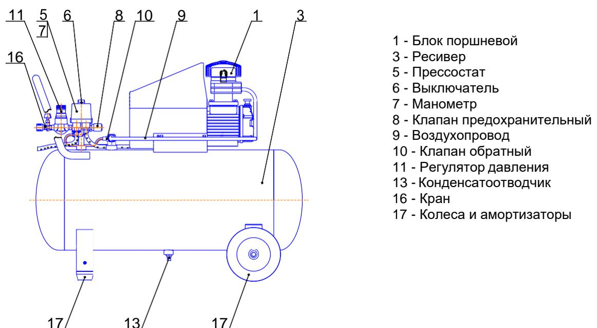
Рисунок 6 - Общий вид компрессора СБ4/С-50.Ј1047В
